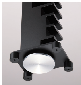
Cubit Jの底面には、本製品自体に発生する振動を抑えることを目的とした円形の5052アルミニウム合金が取り付けられているが、これがT.M.D機構の正体なのだ
